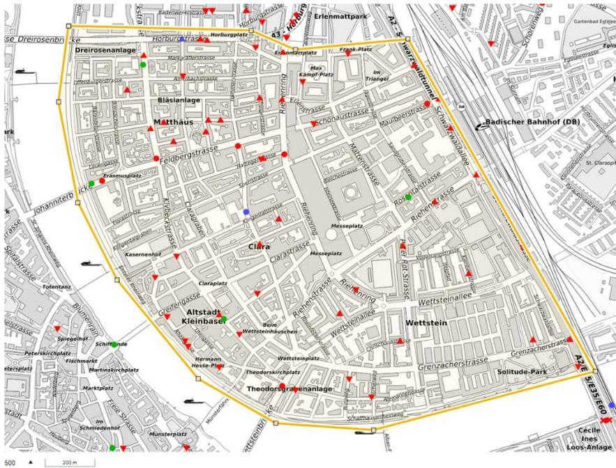
**Abb. 32** Perimeter makroskopisches Fundamentaldiagramm des Kleinbasels, in rot MIV-Messstellen, in grün Velozählstellen, in blau Fussverkehrszählstellen (zum Teil überlagernd); Kartenmaterial: Kanton BS.
